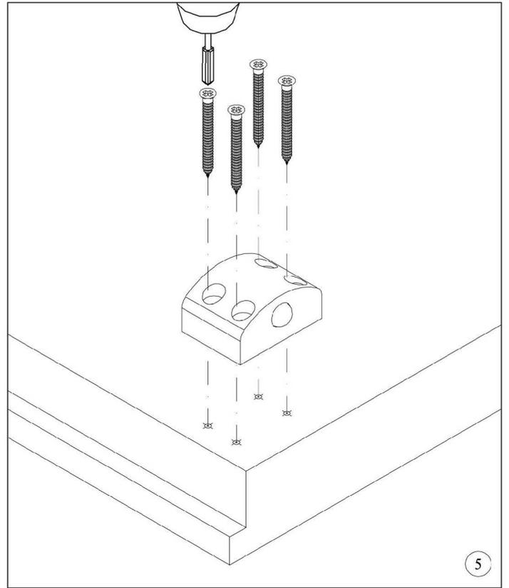
FASE 5 :Montare Machiavello sulle due parti dell'anta semifissa utilizzando le apposite viti autofilettanti in acciaio inox da mm. 4.5X45.
