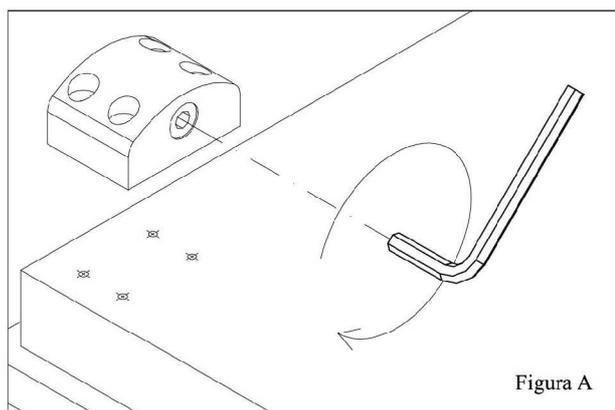
Per ottenere una maggiore pressione sulle sfere, si avvitare con una chiave a brugola i grani che fermano le molle. (figura A)
